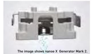
4 | Non è necessaria alcuna manutenzione o sostituzione. nanoe™ X è una soluzione senza filtro che non richiede manutenzione, visto che i suoi elettrodi, parti maggiormente sollecitate, sono rivestiti in Titanio.
